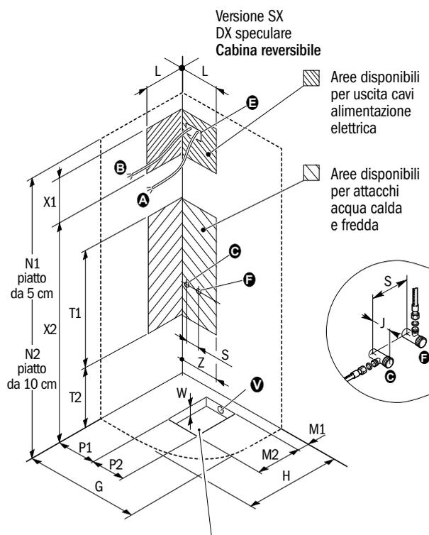
Pozzetto necessario solo per installazione piatto da 5 cm
