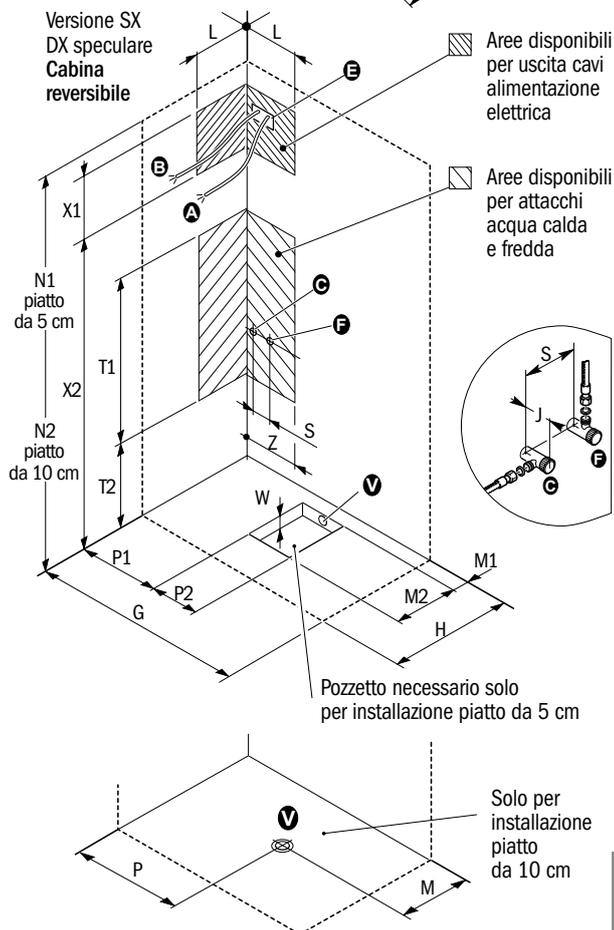
N.B. L'installazione deve avvenire a pavimento e pareti finite. Si consiglia l'installazione di filtri per evitare l'ingresso di impurità nel corpo rubinetto. Per l'installazione richiedere relativa scheda tecnica e attenersi scrupolosamente alle indicazioni ivi contenute.
