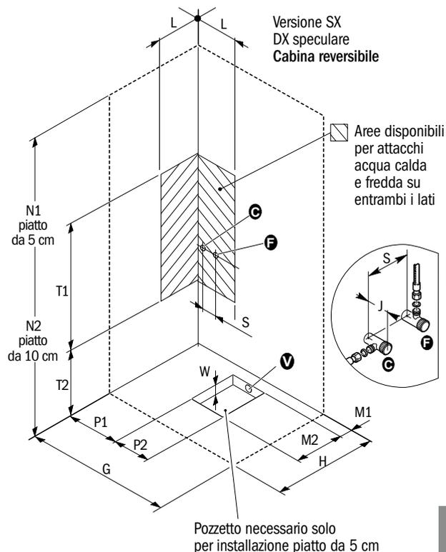
N.B. L'installazione deve avvenire a pavimento e pareti finite. Si consiglia l'installazione di filtri per evitare l'ingresso di impurità nel corpo rubinetto. Per l'installazione richiedere relativa scheda tecnica e attenersi scrupolosamente alle indicazioni ivi contenute.
