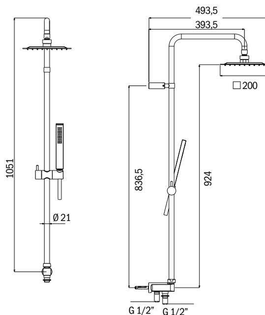
La colonna doccia STORM include il kit di montaggio universale che permette di sostituire qualsiasi vecchia doccia. Viene fornita di tutti i raccordi necessari all'installazione, sia in caso di collegamento ad un miscelatore doccia esterno (A) che in sostituzione di una presa acqua (B). Offre la possibilità di passare da uno a due getti d'acqua senza interventi di opere murarie.
