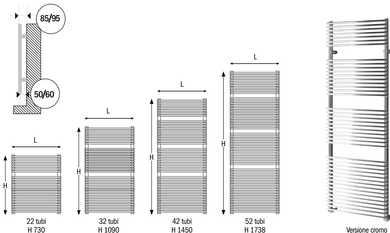
Caldi in tutte le stagioni, i termoarredo BOMA possono anche essere forniti con resistenza elettrica in modo da essere utilizzati anche nelle stagioni intermedie, quando il riscaldamento è spento (funzionamento misto). Non è previsto il funzionamento solo elettrico.
