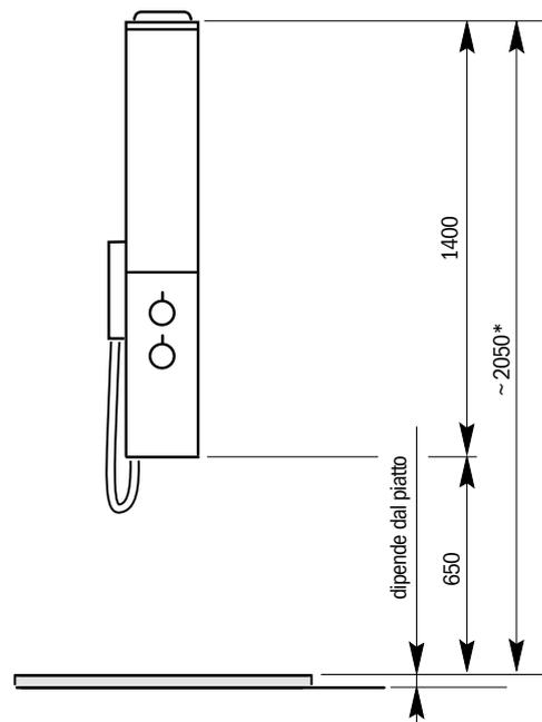
\* In relazione all'altezza desiderata di installazione della colonna eseguire le forature di fissaggio (vedi dettagli J e X)
