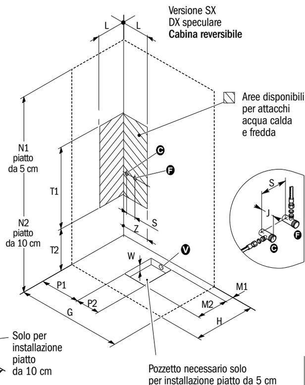
N.B. L'installazione deve avvenire a pavimento e pareti finite. Si consiglia l'installazione di filtri per evitare l'ingresso di impurità nel corpo rubinetto. Per l'installazione richiedere relativa scheda tecnica e attenersi scrupolosamente alle indicazioni ivi contenute.
