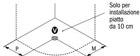
N.B. L'installazione deve avvenire a pavimento e pareti finite. Si consiglia l'installazione di filtri per evitare l'ingresso di impurità nel corpo rubinetto. Per l'installazione richiedere relativa scheda tecnica e attenersi scrupolosamente alle indicazioni ivi contenute.
